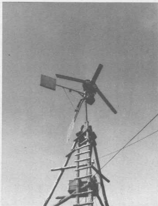
„Wild-romantisch“ auf einem Dreibeinmast aus Baumstämmen, fast 12 m hoch, ein Windrad 2,7 m \phi mit LiMa. (1993)
