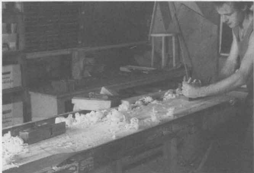
Luvseiten-Schrägstellung mit Schrupphobel und Doppelhobel herstellen
