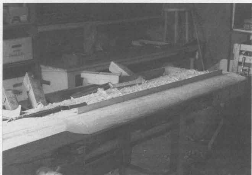
Leeseite zwischen den Meßpunkten geradehobeln, prüfen mit Lineal
