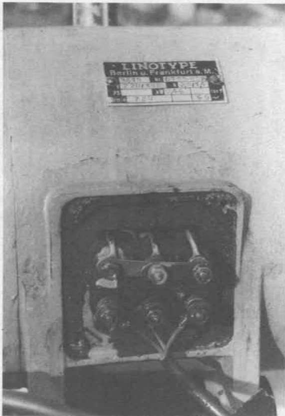
Drehstrom-Motoranschluss (in Sternschaltung, s. S. 61), Typenschild: 0,45 kW Leistung bei 720 U/min, wenn langsamer, weniger Leistung (s. S. 63).
