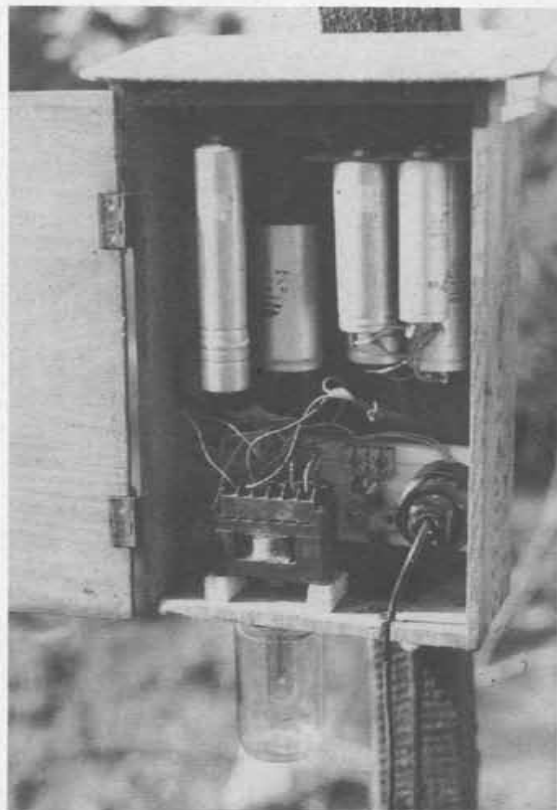
Schaltkasten mit Erregerkondensatoren (s. S. 60/61), Starthilfekond. und Schaltschütz (S. 64), Glühbirne (im Glas) vom „Klick-klack-Trick“ (S. 64).
