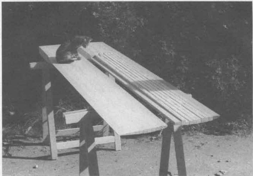
Flügel aus selbstgemachtem Blockleimholz: rechts roh, links fertig
