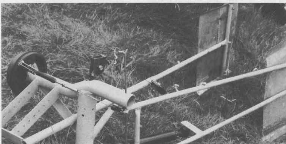
Aus dem vorhandenen Schrott wurde hier der Rahmen (S.43) so. Links Bremszug (S.44), Sturm- und Steuerfahne (S.98) mit Dämpfer u. Seilzug (S.37).
