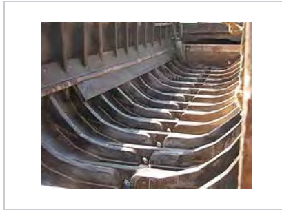
Repaired frames, barge hull. Sa Dec, Mekong Delta.
