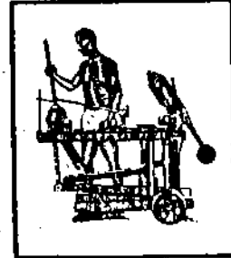
Fig. 5 Pour DÉMÔLER - Laisser retomber la tête droite d'elle-même au moment de la fin de la pression.
