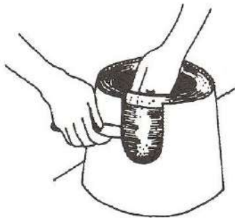
Fig. 4.17 Cutting the door
