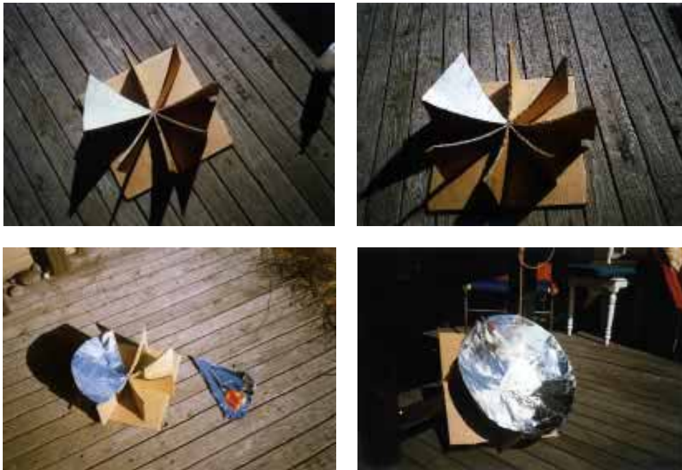
Figur 4: Fotografierne viser, hvorledes man foretager beklædning af solovnen.
