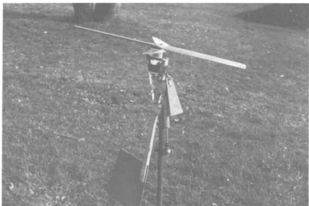
Sturmstellung. Schelle zur Befestigung des Stoßdämpfer-Gelenkes am Mastdrehlager-Rohr aus 2 Stückchen Vierkantrrohr mit zum Mdl.-Rohr passend halbrund gefeilten Aussparungen gebastelt.
