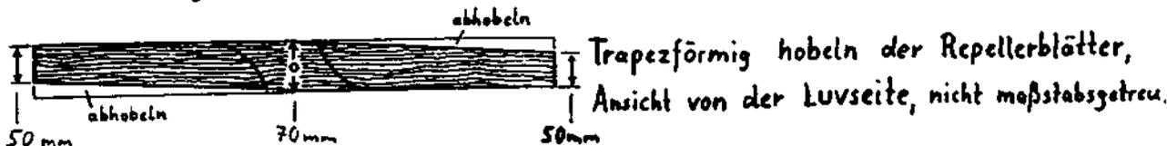
Nun bearbeite die Lee-Seite. Sie soll in jedem Fall zur Nabe hin auslaufen. Das rechteckige Blatt hat auf ganzer Blattlänge das Profil, das in der Maßzeichnung (siehe "Luvseite") abgebildet ist. Die Arbeitsweise entspricht wieder genau der beim Fahrraddynamo-repeller.
