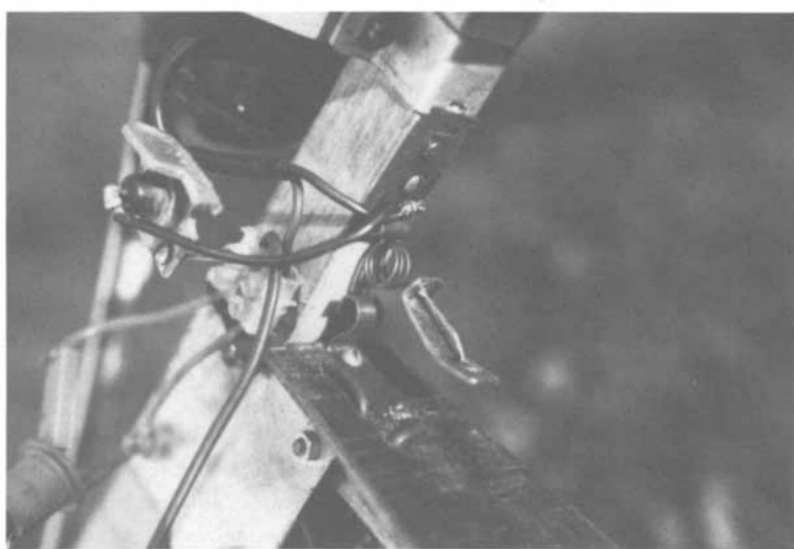
Winddruckschalter. An der Sperrholzplatte ein Kontakt aus Kupferblech. Gegenkontakt-Blech an Spirale aus Messingdraht (aus altem E-Herd) gelötet. Links oben: alte Autolichtmaschinen-Diode. Die Kontakte reiben aneinander und bleiben deshalb gut blank.
