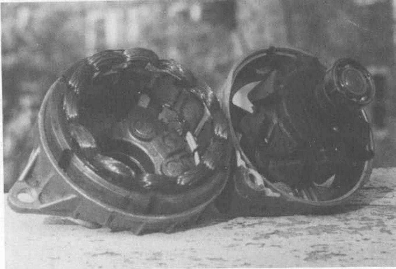
Geöffnete WechselstromliMa mit fertig gewickeltem Stator.
