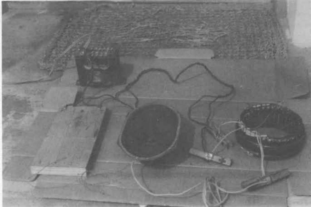
Brettchen mit Widerstandsdraht ↗    ↖ oben: Atom-Trafo    ↖ WINDUNGSSCHLUSS-PRÜFGERÄT? ↗
