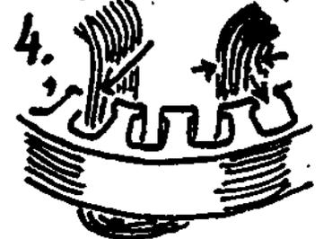
4. Erst jetzt Drahtbündel für Drahtbündel seitlich flachdrücken und nach und nach in die Nuten schieben.
