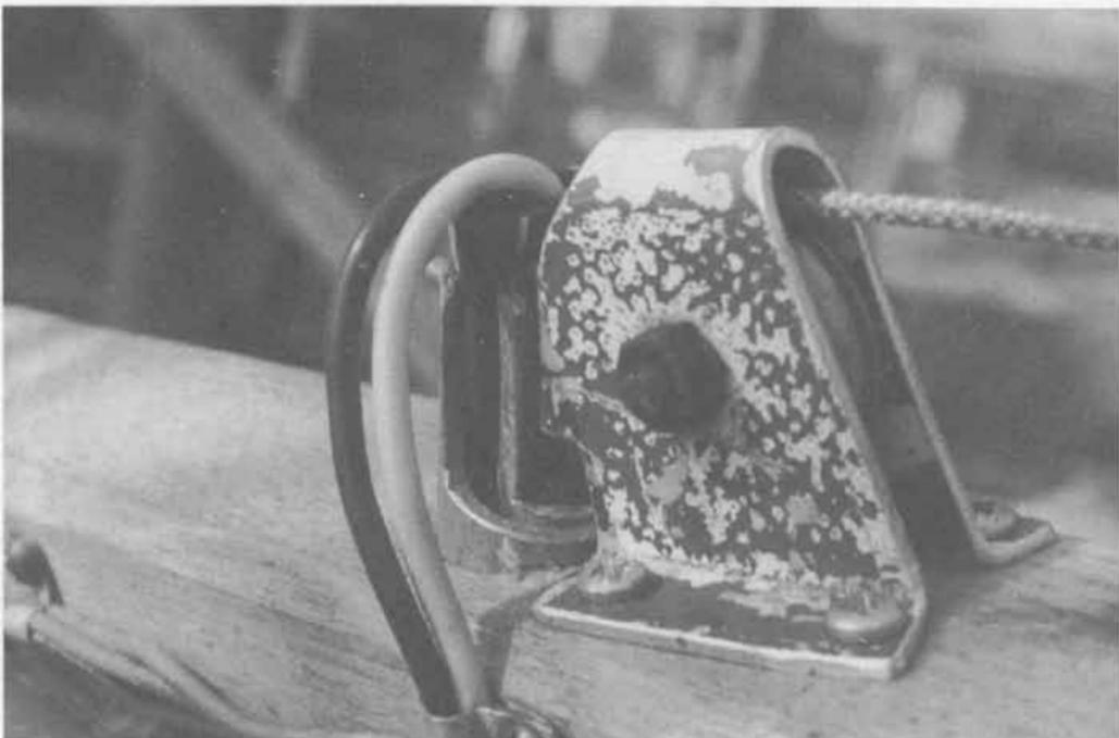
Kabel-/Schlauchbefestigung, daneben Seilrolle im Führungsblech.
