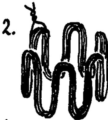
2. Strang in 6 gleiche Wellen biegen (vorher abmessen!), so eng, daß er in den Statorring paßt.
