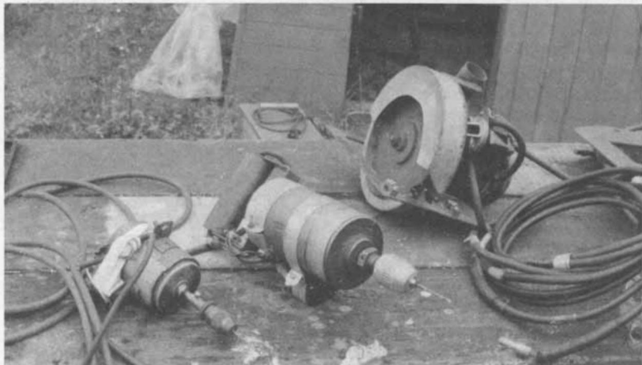
Oben: Links kleine Bohrmaschine mit Kühlergebläsemotor, Mitte große Bohrmaschine, rechts Handkreissäge. Gleichstrom-LiMas als Motoren, für mehr Kraft und Drehzahl sind Feldspulen aus dickem Draht ( vom Anlasser) eingebaut und im Reihenschluß geschaltet. Unten: Die Schweißeinrichtung. Er verwendet nur Schutzwiderstände, verzichtet auf die Drosselspule und schweißt mit 24 Volt. Stromsparend, aber schlechter zündend als mit 36 V.
