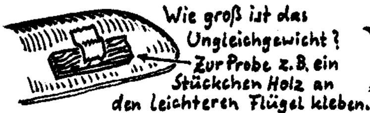
Wie groß ist das Ungleichgewicht? Zur Probe z.B. ein Stückchen Holz an den leichteren Flügel kleben.
