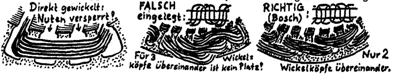
Bei Schleifenwicklung ist die Schablone ziemlich kompliziert. Wenn wir uns schon die Mühe machen, soll es auch das Bestmögliche bringen. Schleifenwicklung Typ 2 (S.12) ist uninteressant, weil die Wickelköpfe ebenso groß wie bei Wellenwicklung werden. Nur Schleifenwicklung Typ 1 ist sinnvoll. Die fertigen Spulen kannst Du so einlegen:
