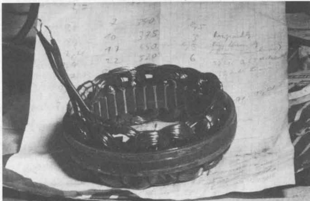
Wellenwicklung auf dem Stator fertig und abgebunden.
