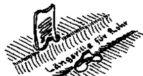
bohren, dazwischen weißeln, zum Rohr hin aufbiegen, Scheile durchstecken.
