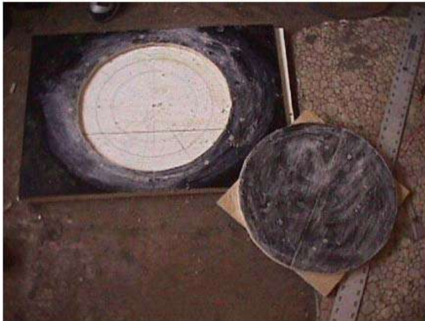
La fotografía anterior muestra un molde que fabricamos de madera marina. El círculo tiene un perímetro de 14 pulgadas y fue dividido en nueve partes de manera de poder colocar las bobinas en sus sitios exactos. La tapa del molde es su corte interno. Tiene un espesor de media pulgada. Nosotros enceramos el molde a fin de
